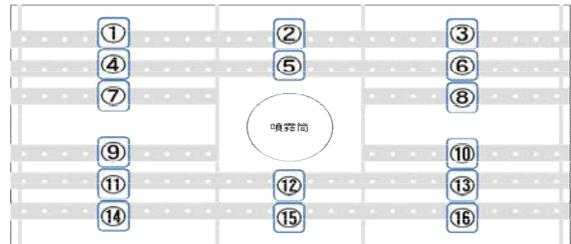
図2 試験片の設置箇所
