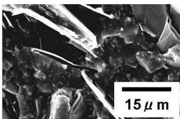
図 8 GP/AIN/PA66 (AIN 混合比:0.5) の FE-SEM 像
