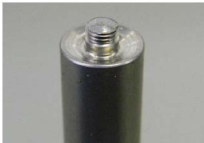
図3 摩擦攪拌スポット接合ツール
