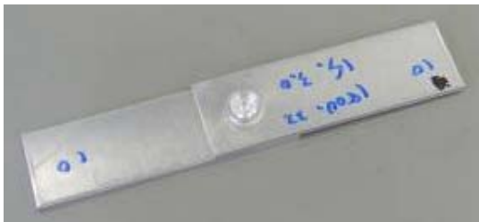
図2 摩擦攪拌スポット接合試験片
