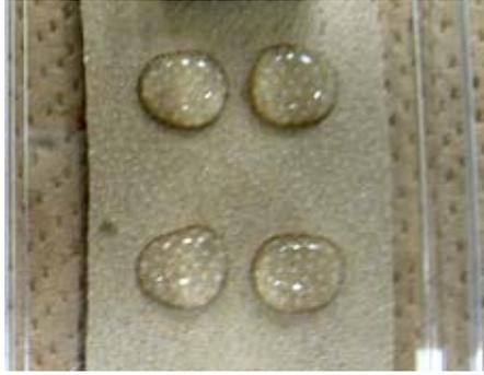
図9 防水試験のシートの様子
