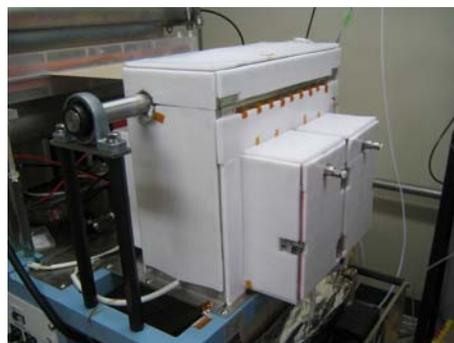
図6 SAM処理炉断熱加工の様子
