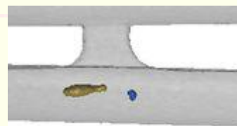
X線CT装置による測定例 成形品中に観測されたポイドの例 (黄色、青色の部分)
