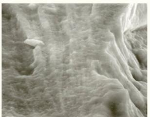
破面の電子顕微鏡観察
