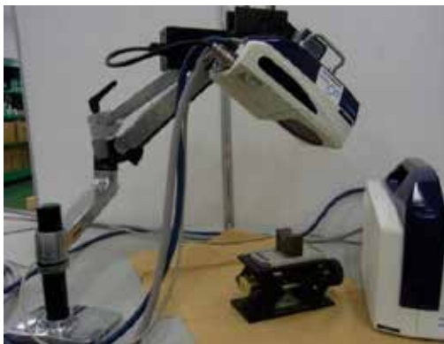
残留応力測定の様子 装置:パルステック工業製 \mu -X360s
