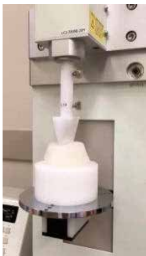
(上)円柱型プランジャーを用いた求肥のテクスチャー解析 (右)くさび型プランジャーを用いたういろの破断強度解析
