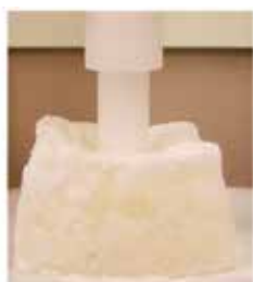
(上)円柱型プランジャーを用いた求肥のテクスチャー解析 (右)くさび型プランジャーを用いたういろの破断強度解析
