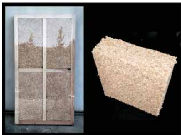
木質断熱・吸音材と住宅の壁体への適用イメージ
