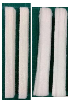
ポリ乳酸繊維製品 (左) 恒温恒湿試験前 (右) 恒温恒湿試験後
