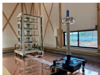
インパルス電圧 発生装置
