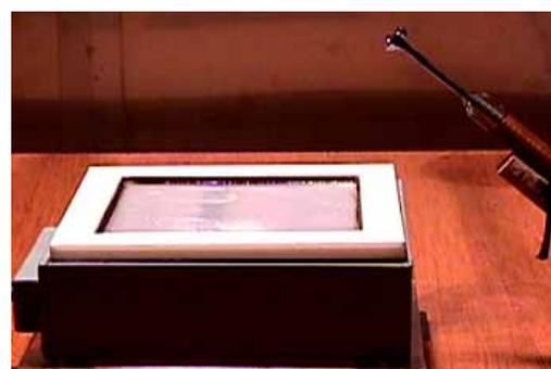
図1 熱損失量測定部
