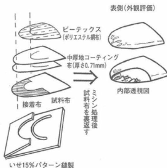
図1 パターン縫製による袖山への接着芯地適用の効果の判定方法
