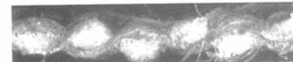
図4 平織物断面写真（経糸2/60、緯糸2/48）
