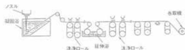
図1 湿式紡糸工程の概略図
