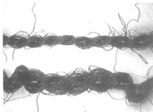
図1 織下後および仕上後の糸の収縮状態 (上: 織下後、下: 仕上後)
