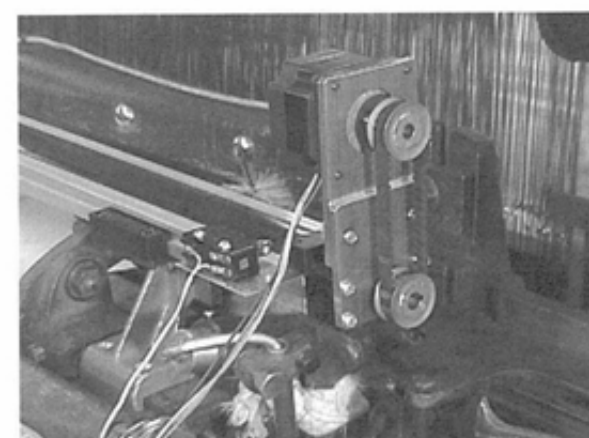
写真4 パルスモータ及び一軸ステージ駆動部
