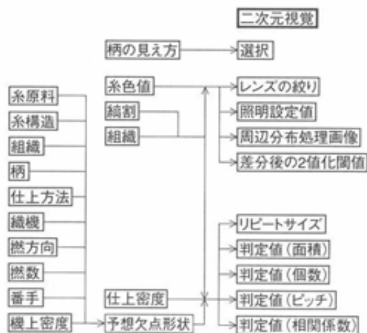
図21 二次元視覚装置のパラメータを求める処理フロー
