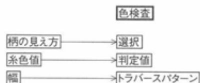
図22 色検査装置のパラメータを求める処理フロー
