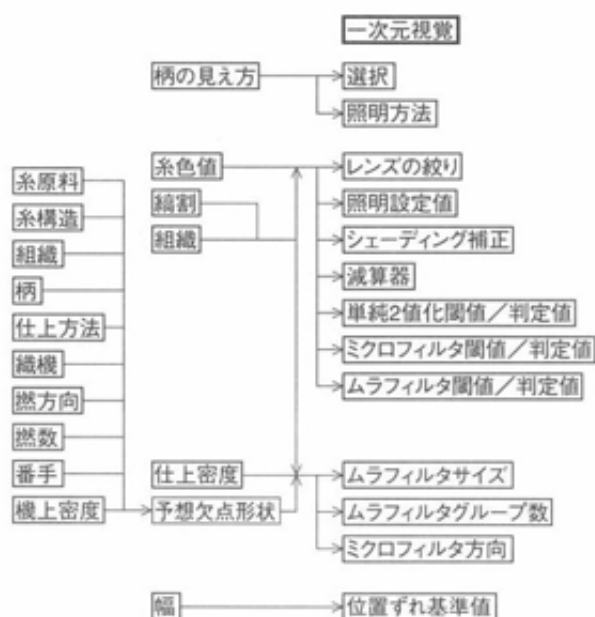
図20 一次元視覚装置のパラメータを求める処理フロー
