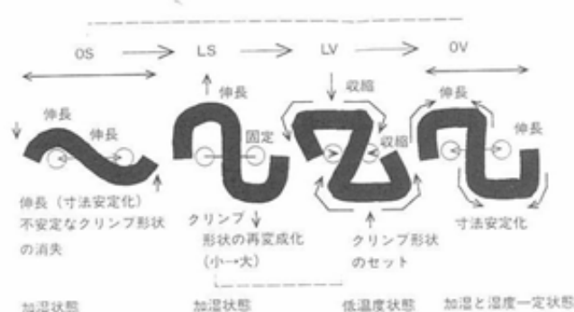
図10 プレス工程での織物伸縮状態の変化
