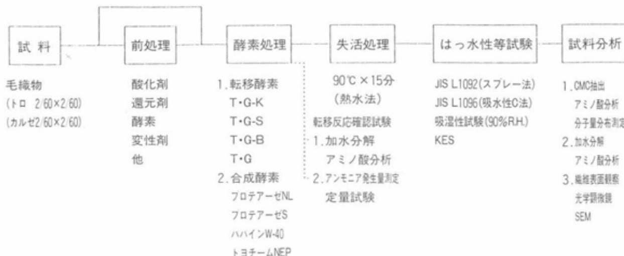
図1 酵素による毛織物はっ水加工試験工程フロー
