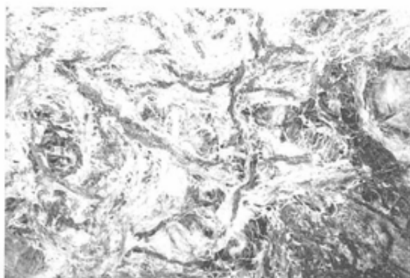
b-1 複合樹脂 発泡スチロール混入(表面, ×6.6)
