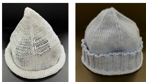
図7 無縫製横編機で試作したニット帽 (左: 4本引き揃え、右: プレーティング編)
