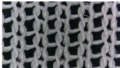
図 5 拡大した導電性ニット(試料③)
