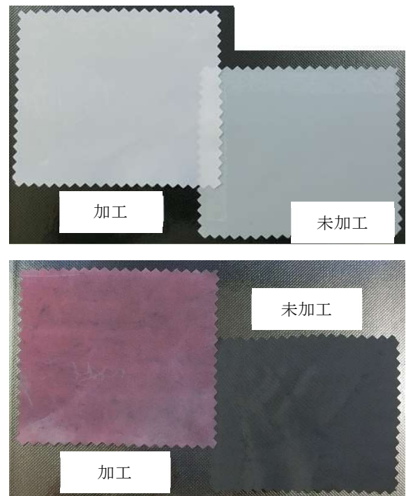
図6 シリカ粒子膜形成による構造発色織物 (上:未染色、下:黒染め)
