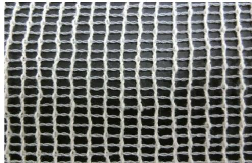
**図 4** 緯糸にコイル状繊維を用いた織物
