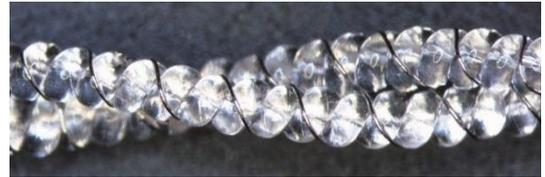
図2 導電糸をカバリングしたコイル状繊維
