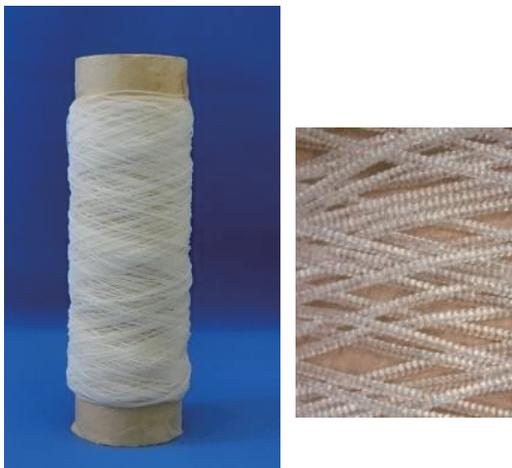
図1 撚糸機を用いて加工したコイル状繊維
