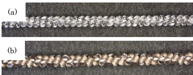
図 1 コイル状繊維の外観 (a)ステンレス線、(b)銀メッキ糸
