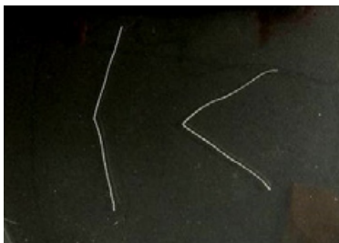
図1 糸開角度法 (左：未加工綿、右：加工綿)
