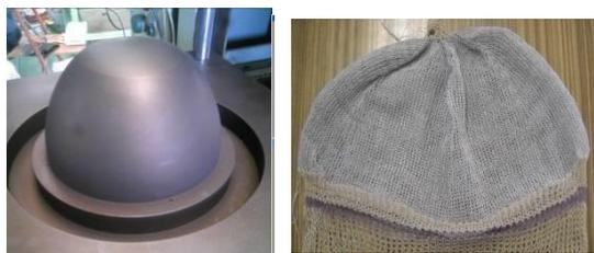
図 2 成形用金型 (左) と編成したカバリング CF 糸 (右)
