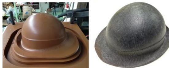
図 4 実用化に向けた検証に使用した金型 (左) と成形品 (右)
