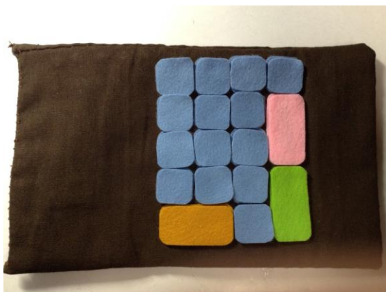
図 3 試作した布キーボード
