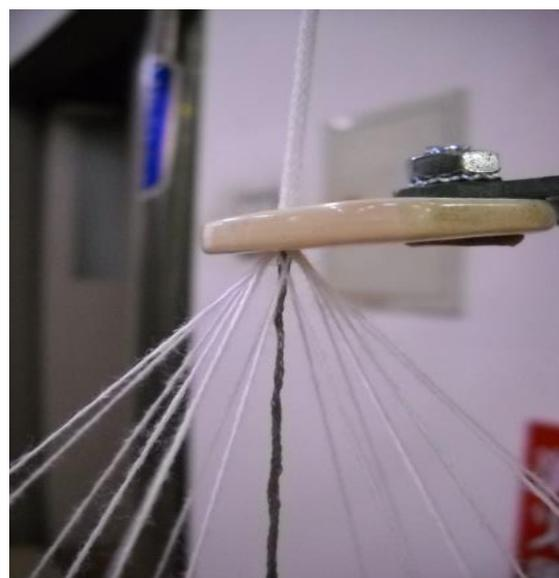
図 1 二重構造 丸組紐の製造の様子
