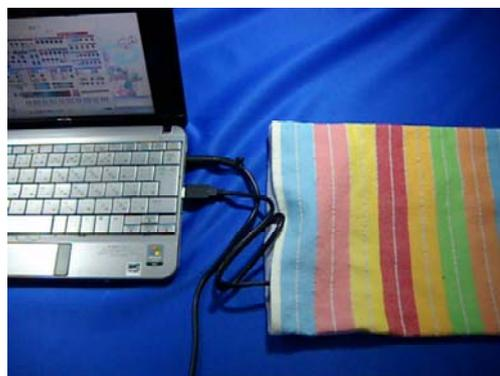
図7 織物のデバイスと小型パソコンの接続実験
