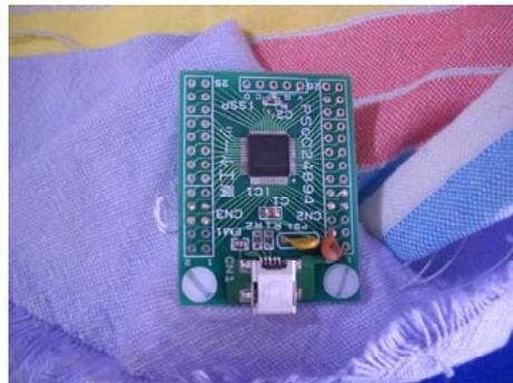
図6 センサ織物の中へ実装した電子回路基板
