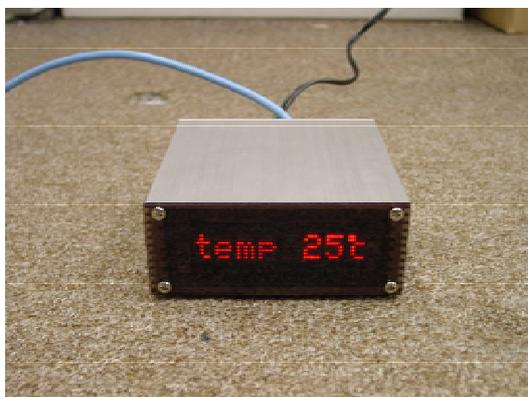
写真 1 温度計測サーバ
