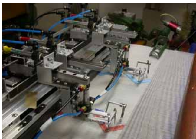
図 3 開発した装置を織機に取り付けた写真
