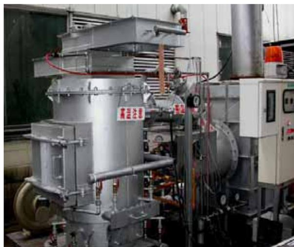
写真 試作溶解炉
