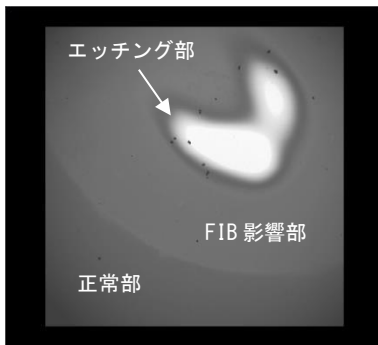
図 1 FIB によりエッチングされた表面の様子
