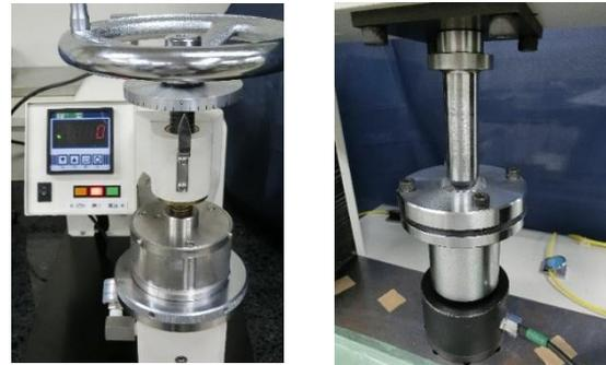
図1 破裂試験装置
