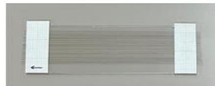
図3 線状試料の試験片
