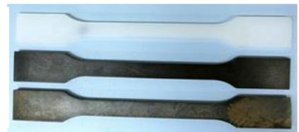
図2 ダンベル試験片
