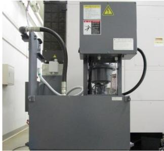
図1 高圧クーラント装置
