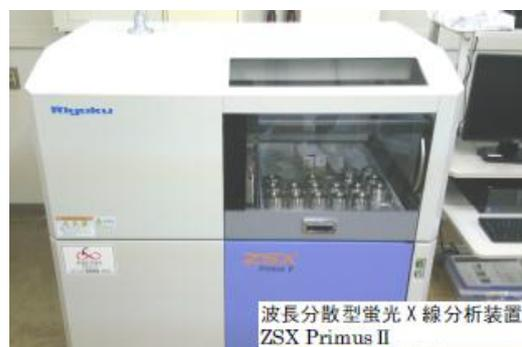
(平成25年度JKA補助事業により導入した「波長分散型蛍光X線分析装置」)
