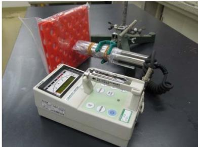
に示すように製品表面にサーベイメータのプロブ先端を近接させ、10-30秒間隔で数回測定し、その平均の数値で表す方法が一般的です。
