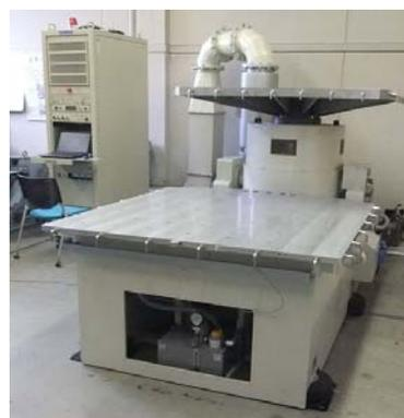
図 1 大型振動試験装置
