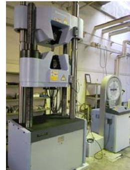
図4 油圧式万能試験機
