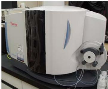
図 1 ICP-AES 装置 (iCAP 6500)
