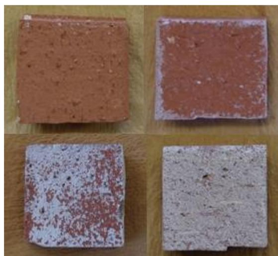
図2 変色試験結果(左上：室温、右上：50℃、左下：60℃、右下：80℃)
