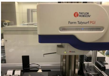
**図1** 表面粗さ・形状測定機
