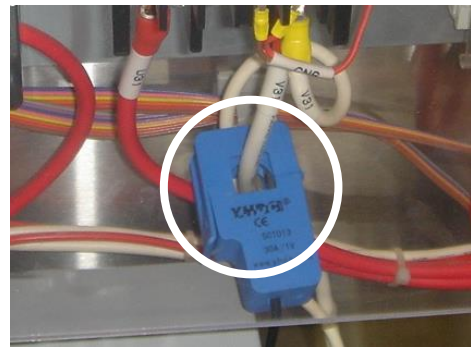
図2 電流センサの取り付け
