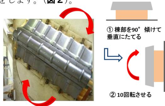
図2 耐震性能試験
