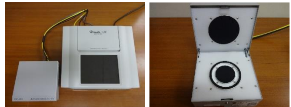
図2 高抵抗率計（左：本体、右：電極）
