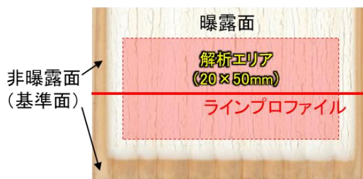
図1 劣化試料の表面性状測定箇所
