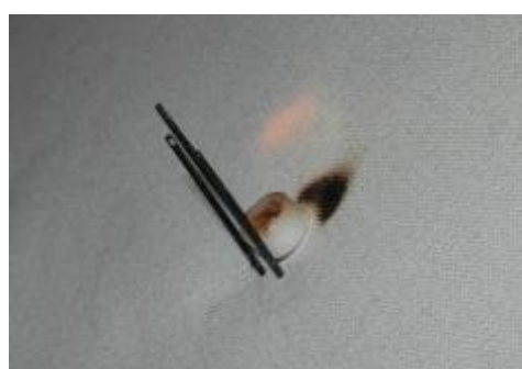
図3 メセナミン錠剤の取付と燃焼の様子
