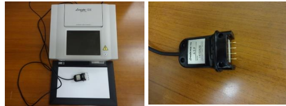
図1 低抵抗率計（左：本体、右：電極）
