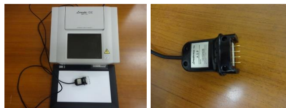
図1 低抵抗率計（左：本体、右：電極）
