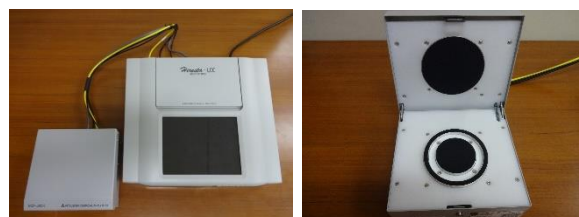
図2 高抵抗率計（左：本体、右：電極）
