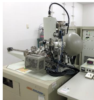
オージェ電子分光分析装置 薄膜(約 50nm)の欠損部評価例
