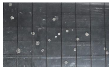
図 2 試験後の腐食欠陥と格子
