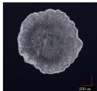
図 1 腐食欠陥部の拡大画像
