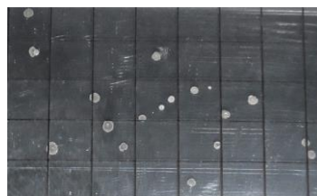
図 2 試験後の腐食欠陥と格子
