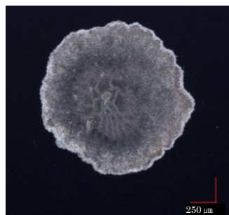
図 1 腐食欠陥部の拡大画像
