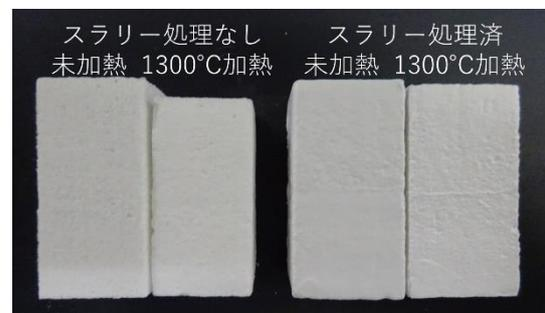
スラリー処理によるセラミックファイバー製品の加熱収縮抑制
